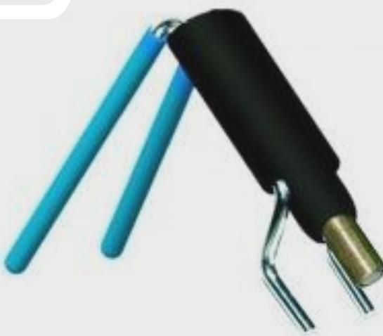
To **Seal Twistor** μπορεί να μειώσει την πιθανότητα ζημιάς εγκατάστασης. Μετατρέπει την τσιμούχα σε σχήμα ωμέγα χωρίς οξεία γωνία (δεν είναι κατάλληλο για εύθραυστα υλικά), καθιστά το μέγεθος της τσιμούχας μικρότερο και μπορεί τοποθετηθεί με ασφάλεια. (**Seal Twistor S 0.7"~1.187", 22~30mm**)
