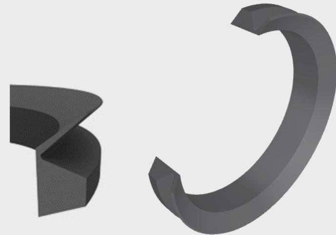
Χρησιμοποιείται πάνω στον άξονα και πρέπει να εγκατασταθεί σε συγκεκριμένη απόσταση από την αντίθετη περιστρεφόμενη μεταλλική επιφάνεια για να επιτευχθεί αξονική προφόρτιση του χείλους στεγανοποίησης. Το άκρο και η θήκη ενός ρουλεμάν ή μία τσιμούχα περιστροφής άξονα χρησιμεύουν ως αντίθετα περιστρεφόμενη επιφάνεια. Ο δακτύλιος περιστρέφεται με τον άξονα και σφραγίζει στην αντίθετη επιφάνεια.
